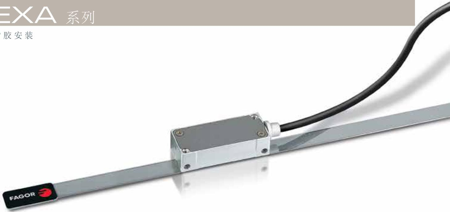
非接触型敞开式光栅尺适用于高精度、高速度的应用场合。所有的电子元件和光学元件都集成在读数头内部，读数头的固定方式比较灵活，通过其顶部或侧面的固定孔都可以固定。
