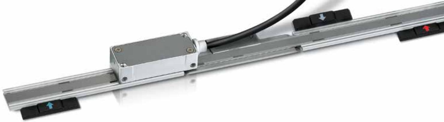
非接触型敞开式光栅尺适用于高精度、高速度的应用场合。所有的电子元件和光学元件都集成在读数头内部，读数头的固定方式比较灵活，通过其顶部或侧面的固定孔都可以固定。
