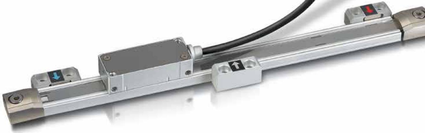
非接触型敞开式光栅尺适用于高精度、高速度的应用场合。所有的电子元件和光学元件都集成在读数头内部，读数头的固定方式比较灵活，通过其顶部或侧面的固定孔都可以固定。
